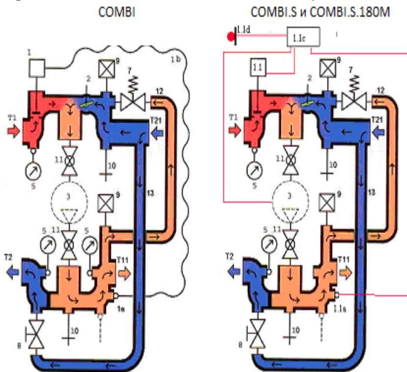
Теплоноситель первичного контура **T1** поступает в насосно-смесительный узел через терmostатический клапан **1 (1.1)**. В
