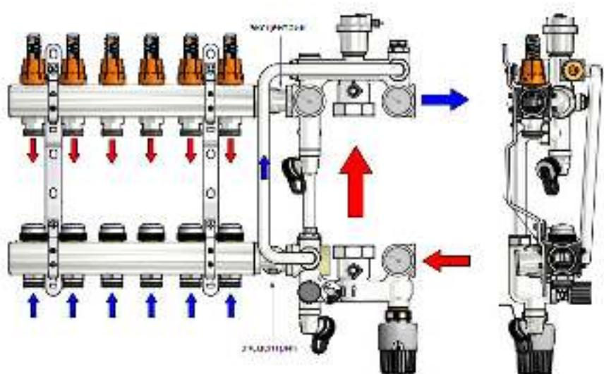
В этом случае для присоединения к коллекторам тёплого пола потребуется дополнительная пара эксцентриков *VTr.094 G1"*.
